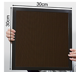
図13 世界最大面積と世界最高変換効率を達成したペロブスカイト太陽電池モジュール
