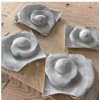
写真9 3Dプリンターで造形された欠損部分
