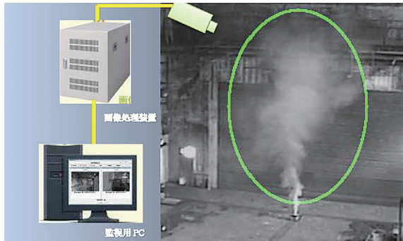
図10 画像処理煙検知システム
